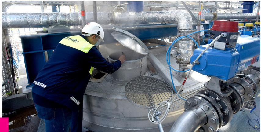
Im sogenannten **Bleichturm** wird das Stroh in verschiedenen Reaktionsbehältern erst in seine Bestandteile aufgeschlossen und dann aufgehellt. Der Turm ist 30 Meter lang, 16 Meter breit, 34 Meter hoch.
