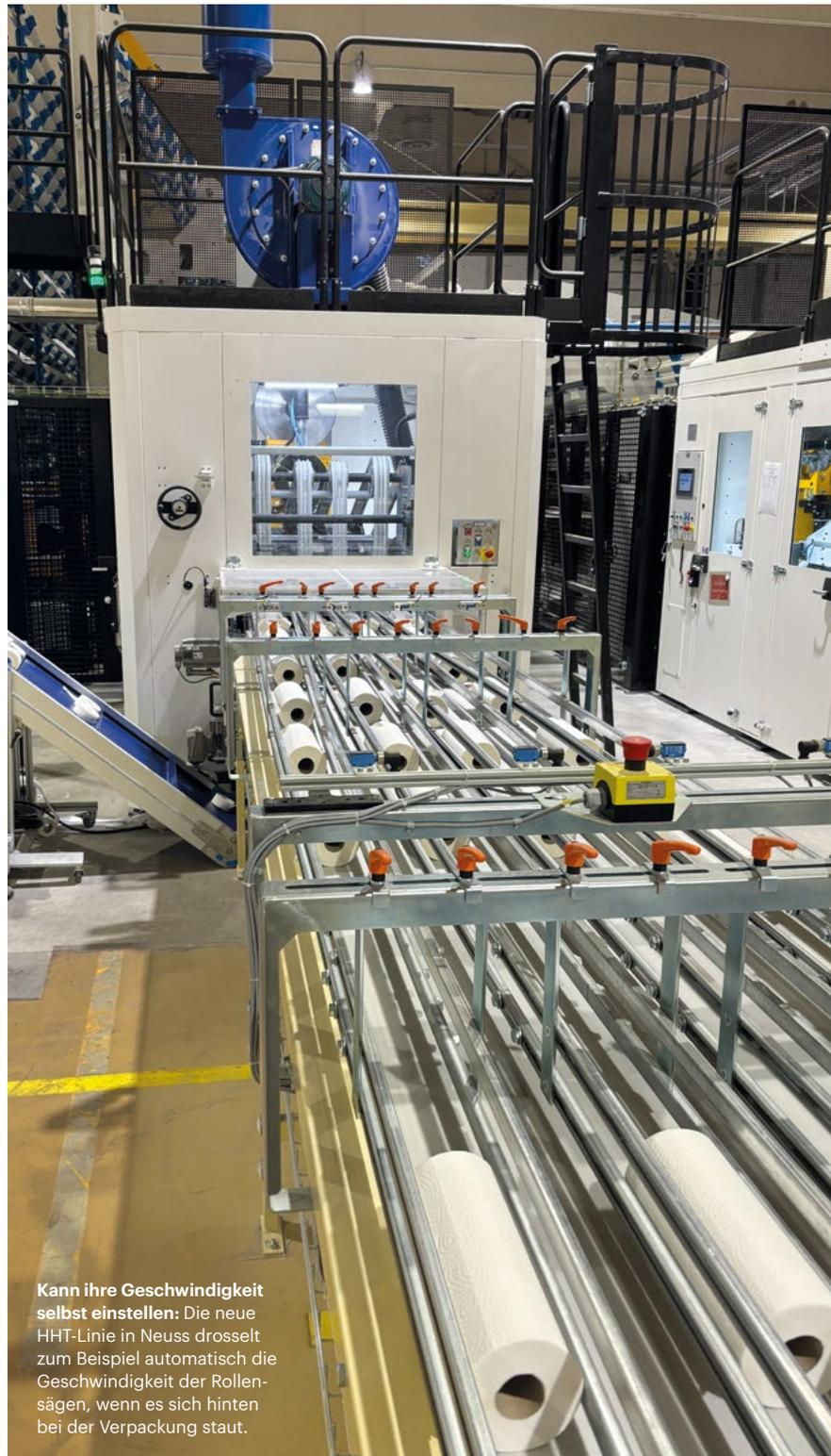
**Kann ihre Geschwindigkeit selbst einstellen:** Die neue HHT-Linie in Neuss drosselt zum Beispiel automatisch die Geschwindigkeit der Rollensägen, wenn es sich hinten bei der Verpackung staut.
